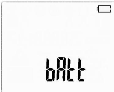
Batterien sind komplett entladen. Messgerät schaltet sich automatisch nach 5 Minuten ab.
